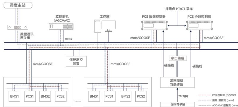
基于多年电站功率管理开发经验，福氏技术开发了储能协调控制器 FS-CCU。该控制器采用新一代保护控制平台，采用 32 位高性能微处理器作为故障检测和功能管理的核心，并配备高速数字信号处理器进行保护计算。其硬件集成度高、可扩展性强、易维护，采用高性能内部通讯总线确保数据通信可靠性，支持分布计算与系统均衡负载，易于扩展系统性能。双重采样通道与冗余 DSP 处理器实现并行处理与实时计算，确保装置可靠安全。
