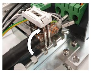
2. Fix the cable with a cable tie:
