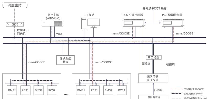
FS-CCU 储能协调控制器基于新一代的保护控制平台开发,采用 32 位高性能微处理器作为故障检测和功能管理的核心,采用高速数字信号处理器用于保护计算。硬件的集成度高,可扩展性强,可靠性好。采用高性能的内部通讯总线,确保了板卡插件间数据通信的可靠性,支持分布计算、系统均衡负载,使系统性能易于扩展。双重化的采样通道和冗余的 DSP 处理器,实现每个采样间隔对采样数据的并行处理和实时计算,保证了装置的可靠性和安全性。
