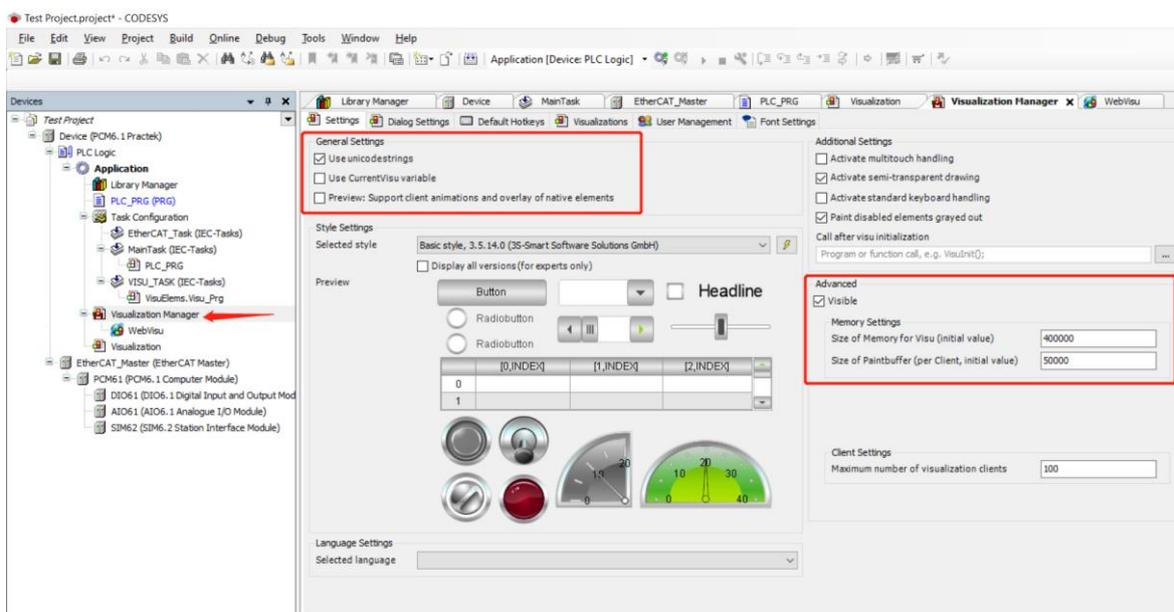
双击“Visualization Manager”下面的“WebVisu”，可以通过修改“Start visualization”设置用户登录到 HMI 界面时显示的首界面，同时在 WebVisu 中还可以对界面的刷新频率、缓存等参数进行设置（通常采用默认设置）。
