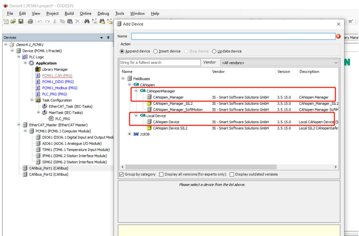
由于 PCM6.1 模块具有两个 CAN 接口，下面将 CAN 接口 1 配置为 CANopen 主站，将 CAN 接口 2 配置为 CANopen 子站，使其相互通讯。参考例程 Demo4.1\_PCM6.1。
