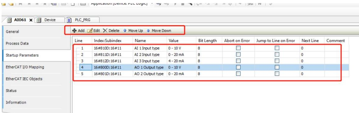
模拟量数据需要标定计算，0~10V/0~20mA 线性对应 0~32767，参考例程
