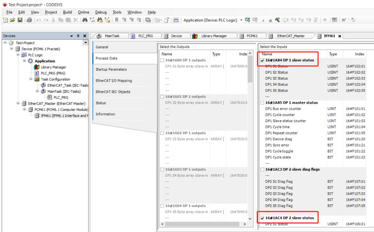
程序中声明数据输入输出数组（122 字节）和子站状态变量以后，在“EtherCAT I/O Mapping” 页面关联 DP 数据 slave-in/master-out 和 slave-out/master-in 数组以及 DP 子站状态变量。
