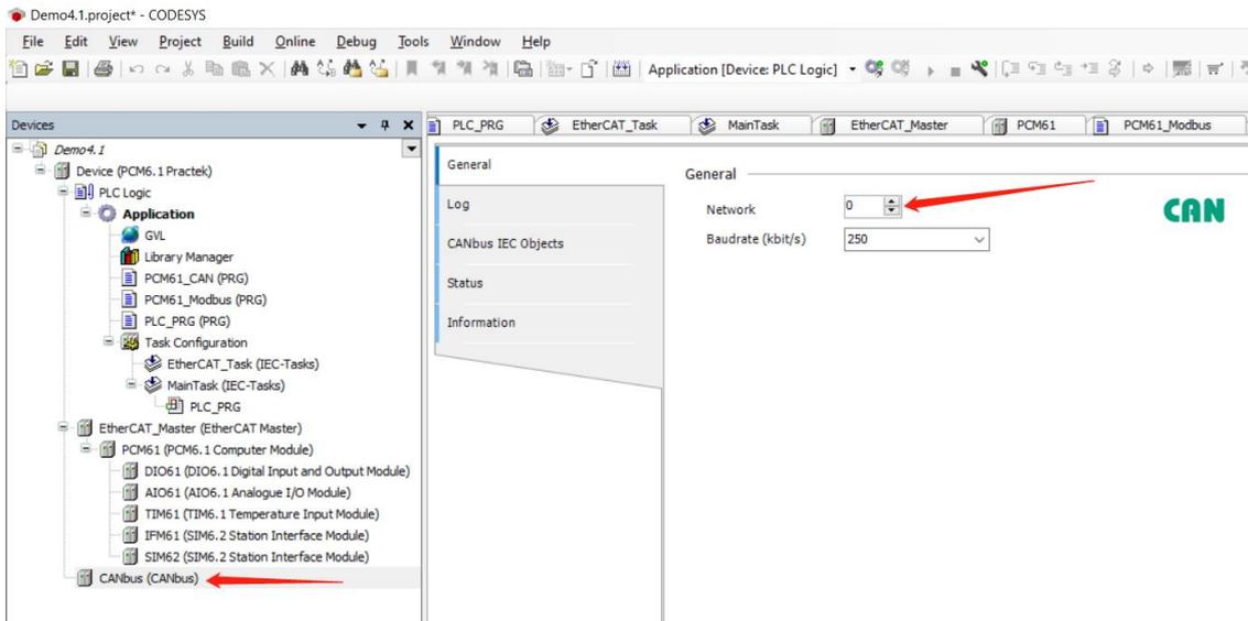
右键点击刚添加的“CANbus”，弹出窗口“Add Device/Fieldbuses/CANopen”有两种选择：
