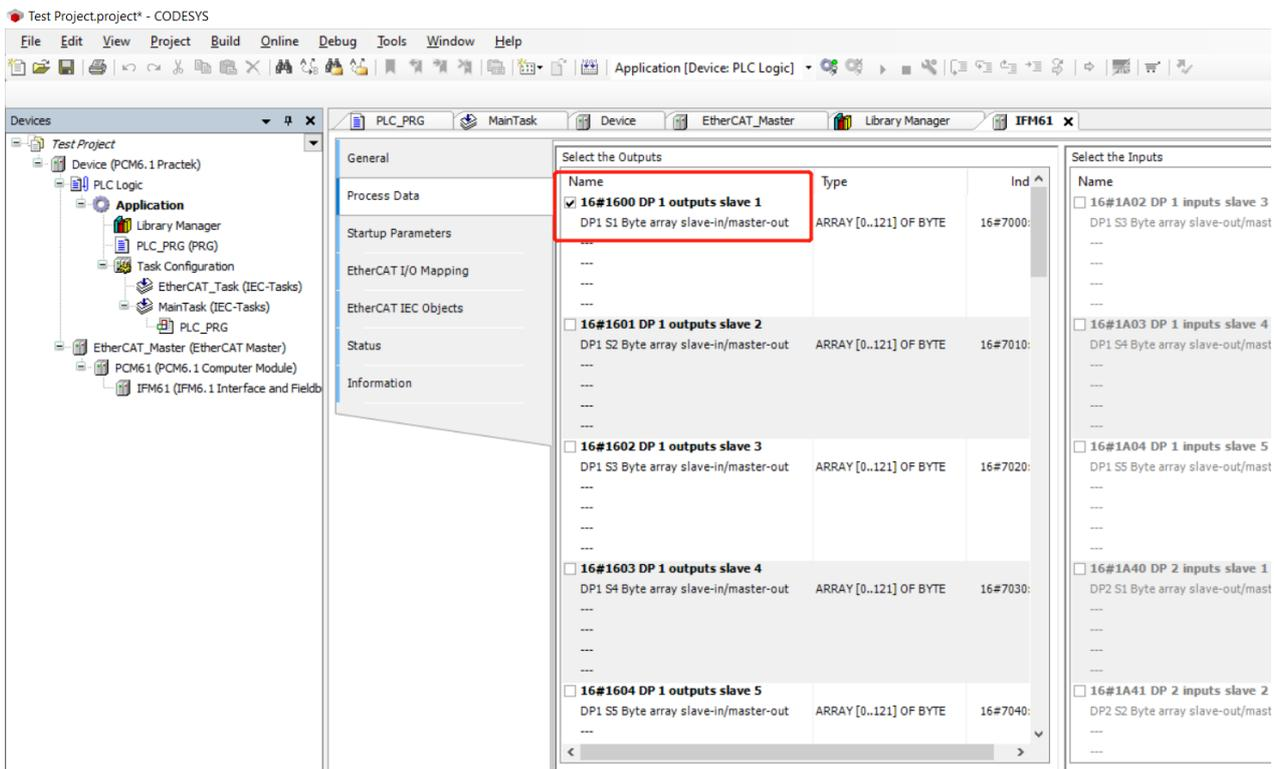
单击“IFM61”、“Process Data”进入 Process Data 配置页面。在“select the Inputs”分组内取消“16#1B02”和“16#1B03”的勾选，勾选“16#1A00”、“16#1A40”。这样就设置了 Profibus Inputs 的 DP1 slave1 和 DP2 slave1。如果有两个子站同时连接主站，那么需要继续勾选“16#1A01”和“16#1A41”，设置 Profibus Inputs 的 DP1 slave2 和 DP2 slave2。
