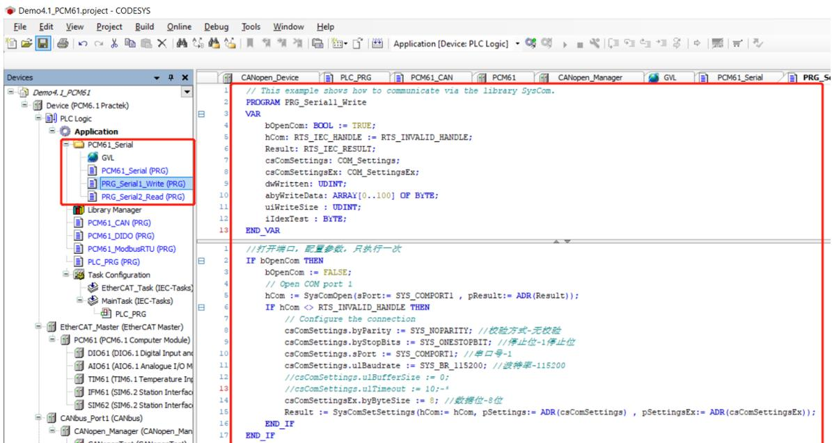
采用 Modbus-RTU 主站通信时，端口选择、校验方式、停止位、波特率、数据位以及调用 Libmodbus 库函数的使用，全部通过代码实现。
