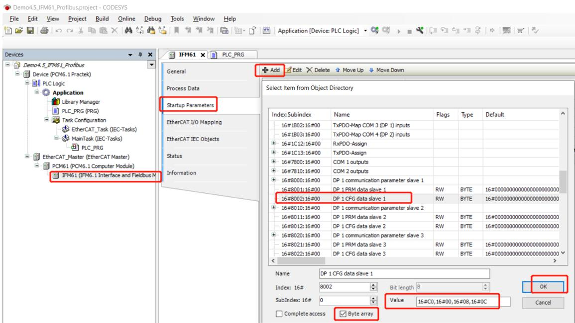
IFM6.1 Profibus DP 启动参数设置参考例程 Demo4.5\_IFM61\_Profibus, DP1 端口启动参数设置完成如下所示, DP2 启动参数设置方法相同。
