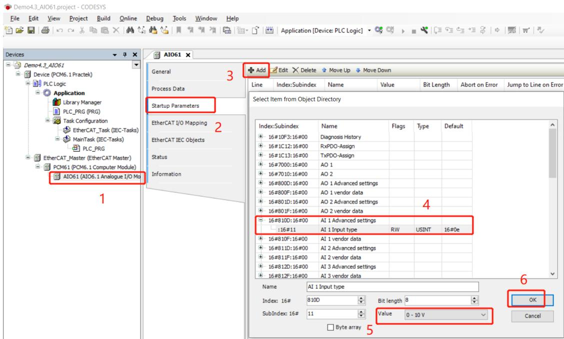
模拟量启动参数设置完成后，可以通过工具栏进行编辑、删除、上移、下移操作。每次点击“Add”添加只能配置一个通道的启动参数，配置多个参数需要多次点击“Add”。
