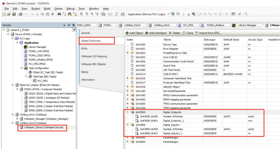
点击 “Edit SDO Parameter Area”，可以配置从站的 SDO 通讯，这里添加一个 USINT 类型的输入和一个 USINT 类型的输出。
