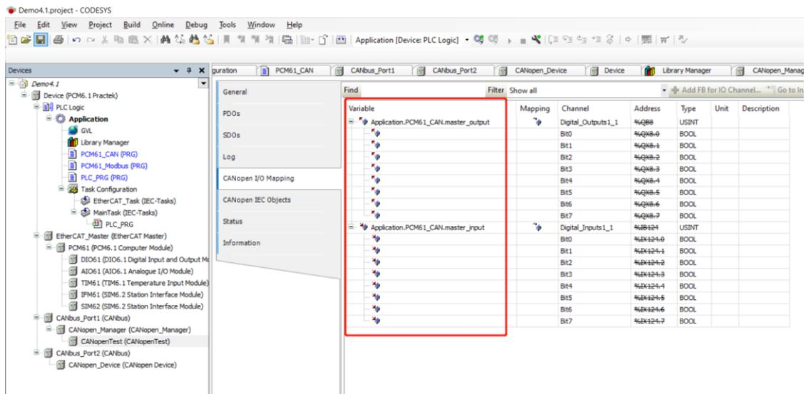
正常通讯阶段，写入和读取 SDO 数据不能通过在 CANopen I/O Mapping 中关联变量的方式进行，而需要使用库函数 CiA405.SDO\_READ()以及 CiA405.SDO\_WRITE()来实现，而且 CODESYS 对 CAN Network 的编号自 0 开始，而 CiA405 对 CAN Network 的编号自 1 开始。
