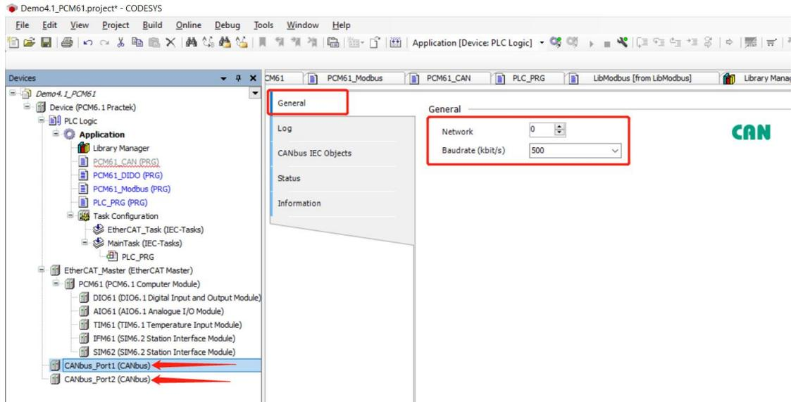
(2) 点击 “CANbus\_Port2” 添加 “Local Device/CANopen Device”，并在 “CANopen\_Device/General” 标签中将 “Node ID” 设置为 1。
