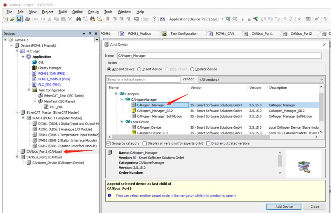
(7) 右键点击刚添加的“CANopen\_Manager”，选择“Add Device”，弹出口选择已经完成添加的子站设备。
