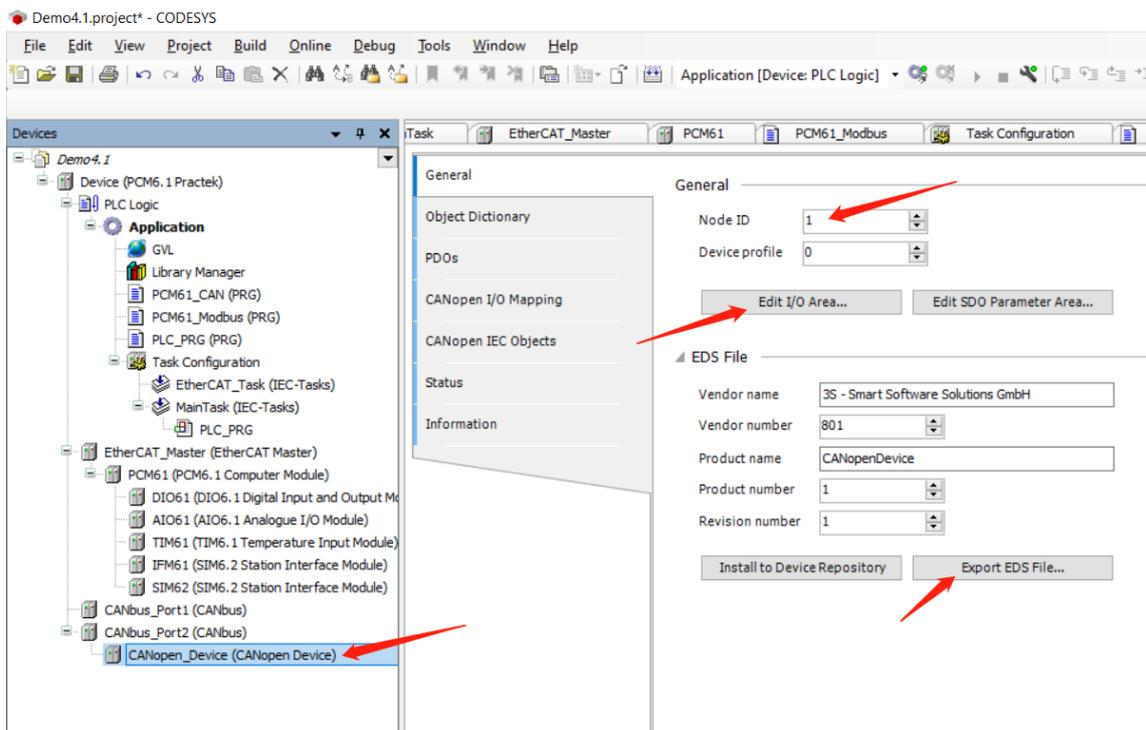
点击“Edit I/O Area”、“Add Area”，添加输入输出数据通道配置，这里添加一个 USINT 类型的输入和一个 USINT 类型的输出。
