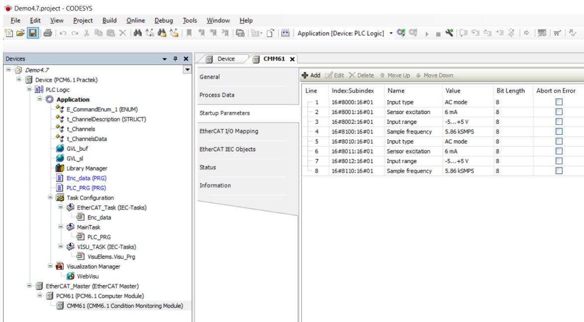
CMM6.1 硬件通道链接只能通过代码定义“AT” CMM61 数据地址，不可以使用 CMM61 中“Mapping”。
