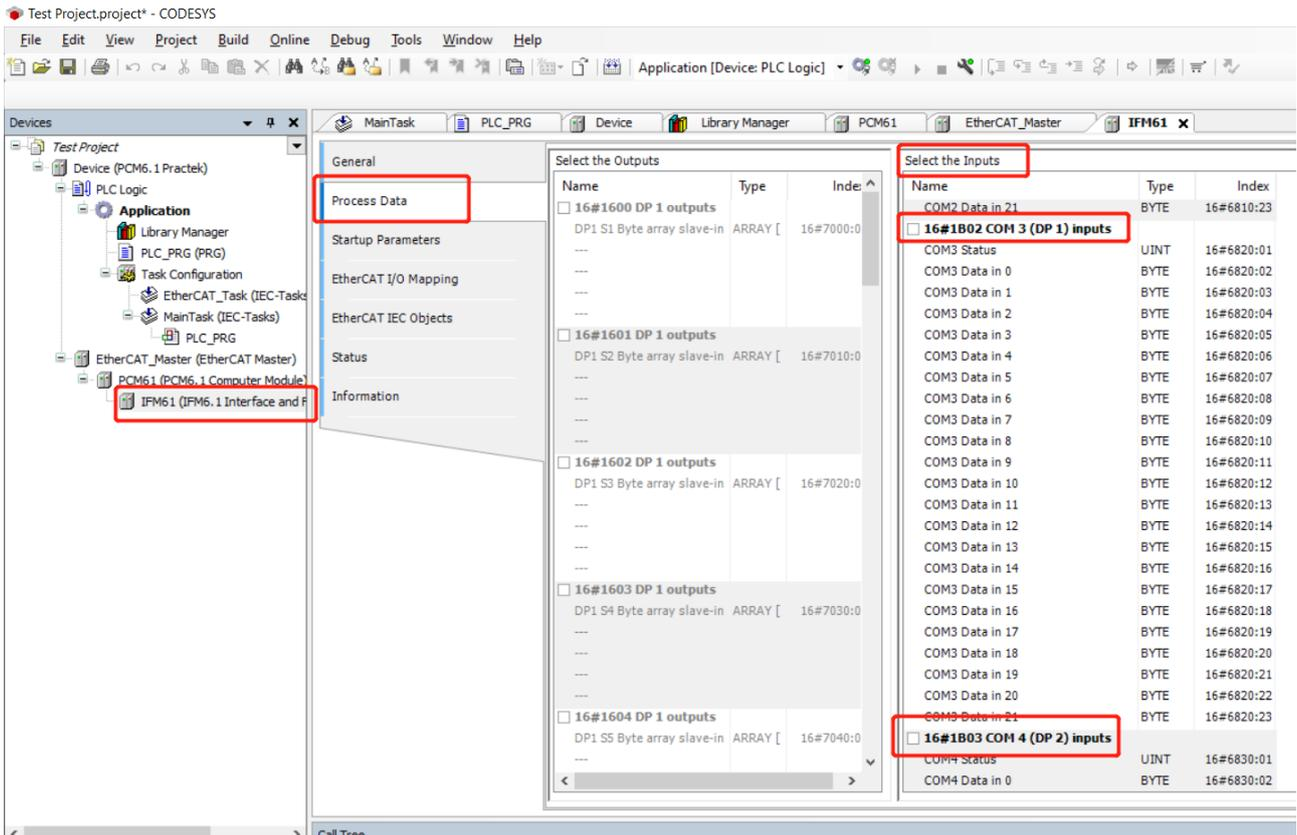
在 “select the Inputs” 分组内勾选 “16#1A84” 、 “16#1AC4” ，这样就设置了 Profibus Inputs 的 DP1 和 DP2 子站通信状态。
