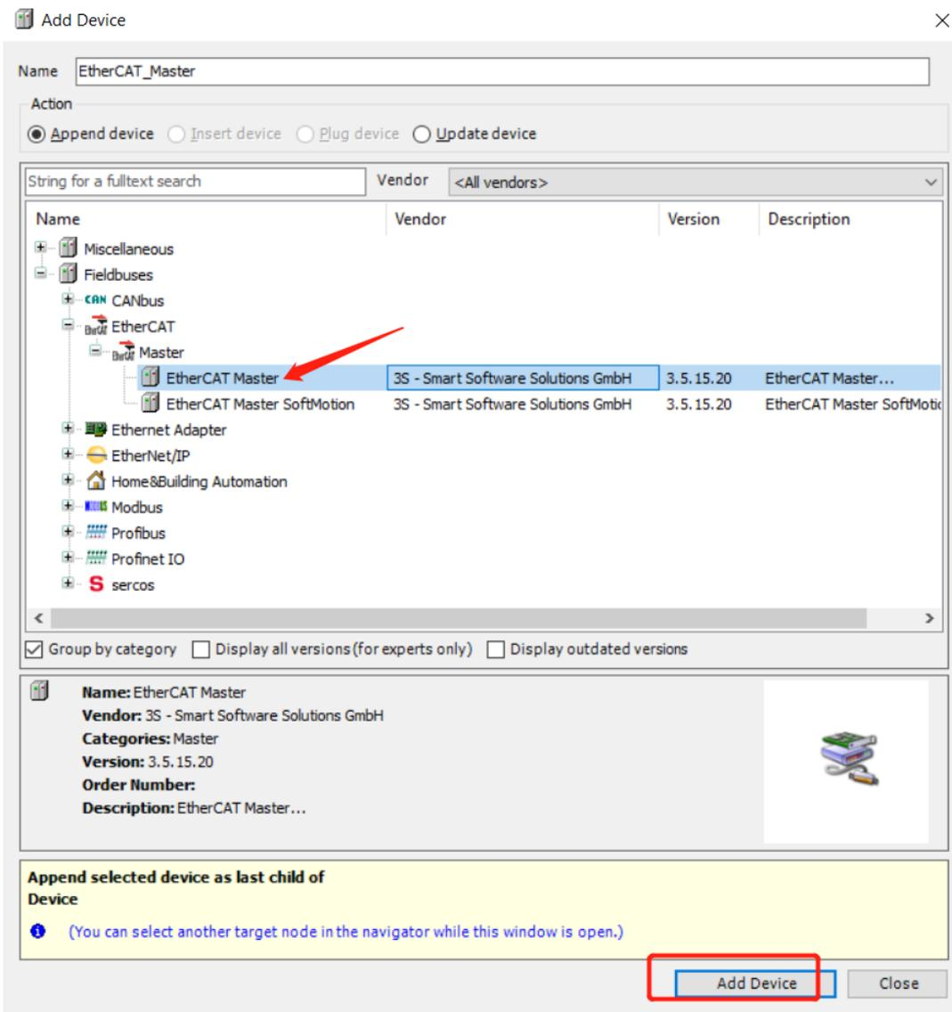
➤ 完成 EtherCAT Master 添加，同时 “Network Name” 处填写 “ecat0” 且点选
