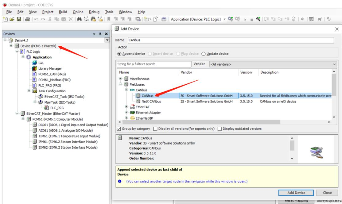
点击新添加的“CANbus/General”，将“Network”设置为0，即使用PCM6.1的CAN接口1。CAN Network编号在控制器内部是从0开始编排的，即PCM6.1的CAN接口1对应Network编号为0，PCM6.1的CAN接口2对应Network编号为1。当AWP100配置其他CAN功能模块时，其CAN接口将依次被编号为2、3、4等。
